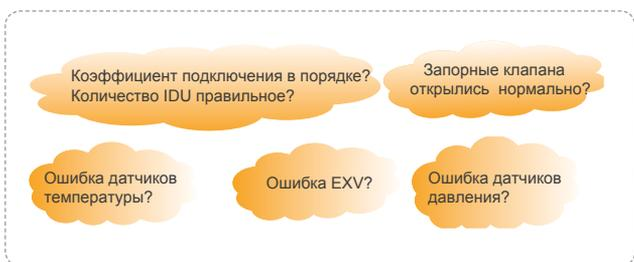
При запуске системы наружная плата проверяет состояние и показывает соответствующий код ошибки в инженерном режиме. Информация об авариях при запуске упрощает наладку системы и исключает повреждение оборудования.
