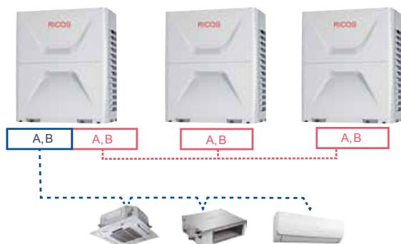
Отсутствие полярности в проводе связи. Это упрощает монтаж, запуск и наладку системы. Для подключения связи между блоками достаточно двухжильного экранированного кабеля.
