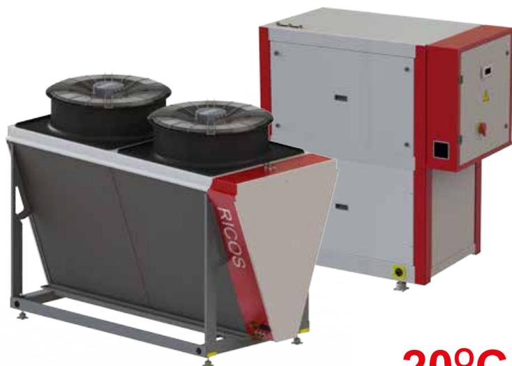
Тепловой насос SPLIT-конструкции для производства охлажденной/горячей воды с герметичными спиральными компрессорами, работающими на экологически безопасном хладагенте. Данное оборудование укомплектовано осевыми ЕС-вентиляторами, медно-алюминиевым конденсатором, пластинчатым паяным теплообменником и электронным расширительным вентилем. Корпус изготовлен из оцинкованной и окрашенной стали.
