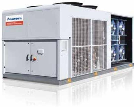
Автономный кондиционер с функцией теплового насоса, типа «воздух-воздух», для нагрева/охлаждения, фильтрации и обновления воздуха в средне-больших и больших помещениях, таких как супермаркеты, торговые или выставочные центры. Герметичные спиральные компрессора с хладагентом R410A; двойной контур хладагента с электронными расширительными клапанами; ЕС-вентиляторы являются стандартными для этих устройств.
