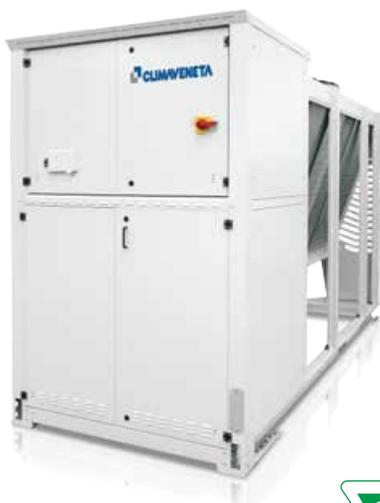
Агрегат наружной установки для охлаждения воды. В стандартной комплектации оснащен одним холодильным контуром с одним нерегулируемым и одним инверторным компрессорами, оптимизированными для работы с хладагентом R410A, осевыми вентиляторами, полностью алюминиевыми микроканальными оребренными теплообменниками и электронным терморегулирующим вентилем.
